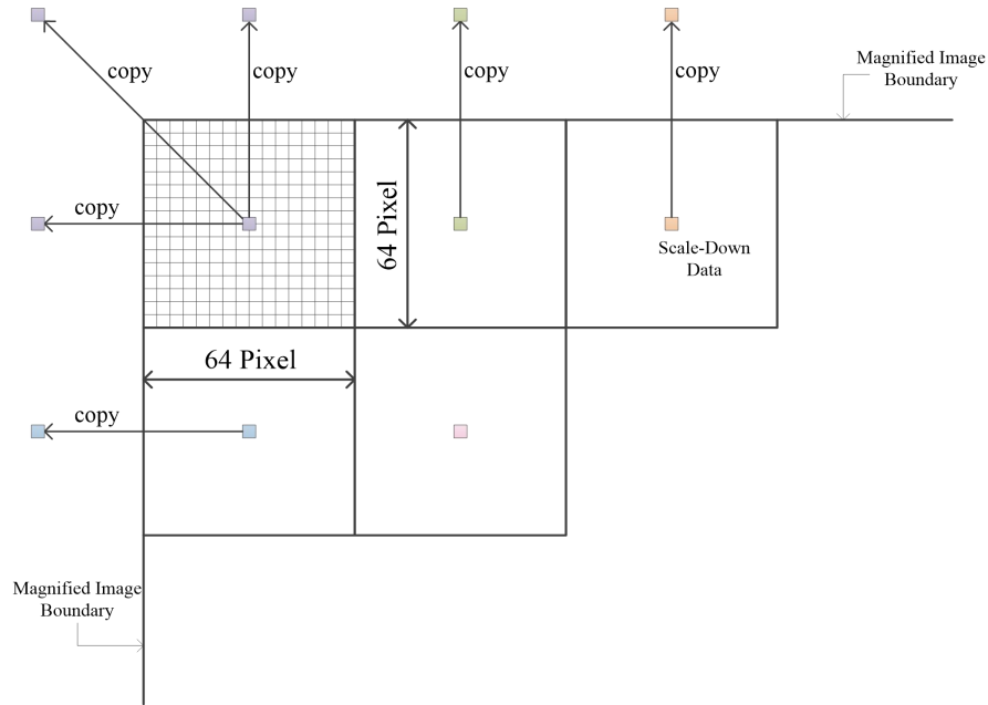
图 27 平场校正原理图
